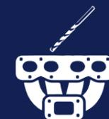
Sin necesidad de taladrar el colector de admisión en la instalación para los modelos Tivoli y XLV (adaptadores dedicados para los inyectores de gasolina).
