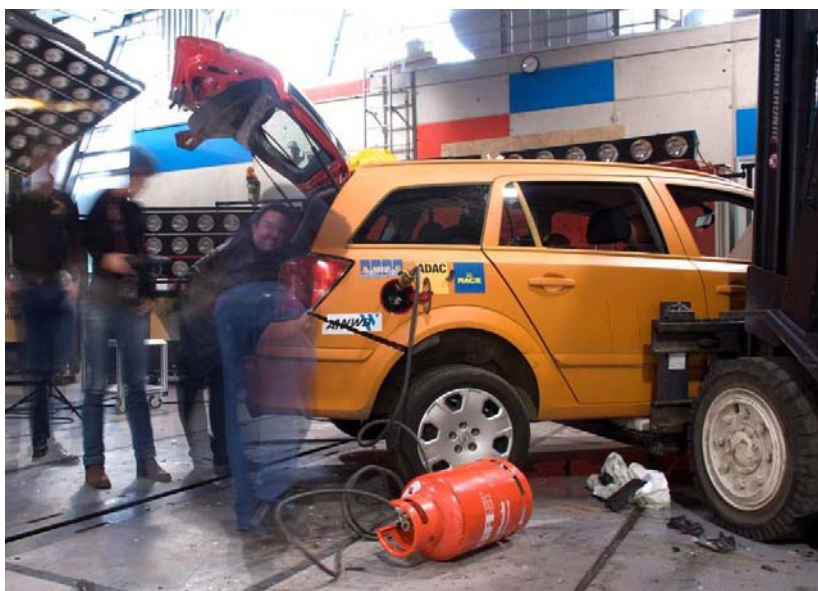
Figura 6: recarga del depósito de Autogas después de la prueba de choque.
